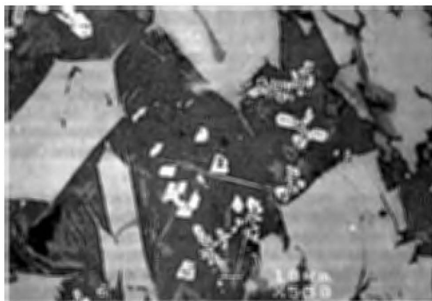
Abb. 9. Rasterelektronenmikroskopische Gefügeaufnahme eines weitgehend aus dem schmelzflüssigen Zustand erstarrten Schlackenkorns; 1 Fayalit, 2 Magnetit, 3 polykristalline mikroanalytisch nicht mehr weiter auflösbare Matrix
